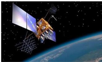
Le GPS comprend une constellation d'au moins 24 satellites NAVSTAR orbitant à une moyenne de 20 200 km d'altitude. Ces satellites évoluent sur 6 plans orbitaux décalés de  $60^\circ$  entre eux, ayant une inclinaison d'environ  $55^\circ$  par rapport au plan de l'équateur. Ils suivent une orbite quasi-circulaire qu'ils parcourent en 11 h 58 min 2 s, soit un demi-jour sidéral. Ainsi, les satellites, vus du sol, reprennent la même position dans le ciel au bout d'un jour sidéral.
