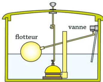
Quand le réservoir est vide, la vanne est grande ouverte, le débit est maximal. Au fur et à mesure que le réservoir se remplit, le flotteur monte, la vanne se ferme de plus en plus et le débit diminue progressivement jusqu'à l'arrêt complet.
