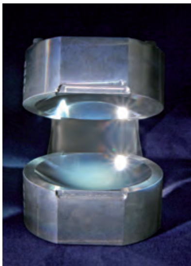
Figure 7. la lumière à contrôler est un champ électromagnétique d'une fréquence voisine de 10 GHz confiné entre les deux miroirs supraconducteurs qui se font face comme sur la figure. Ils forment ainsi une cavité ouverte sur les cotés. La mesure repose sur des atomes (non représentés sur la figure) qui traversent horizontalement la cavité à mi-chemin entre les deux miroirs. Ces atomes interagissent avec le champ électromagnétique et sont mesurés ensuite à leur sortie. Pour la commande, on dispose d'une source électromagnétique classique réglable (non représentée sur la figure) qui, après chaque atome, éclaire à la façon d'un flash la cavité.
