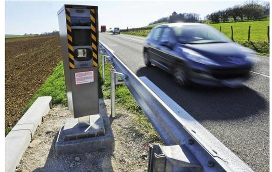
Le radar ne mesure pas directement la vitesse réelle du véhicule mais la vitesse à laquelle le véhicule s'approche de lui (ou s'éloigne si le radar « prend » par l'arrière).
